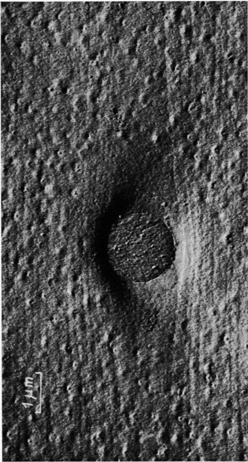
Abb. 1. Bruchfläche eines Opalglases; Beschallung 1 MHz; Elektronenmikroskopische Abdruckaufnahme (Bruchrichtung in Abb. 1—4 stets von oben nach unten).
